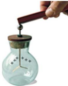
**Figura 2:** Electroscopio de aguja
